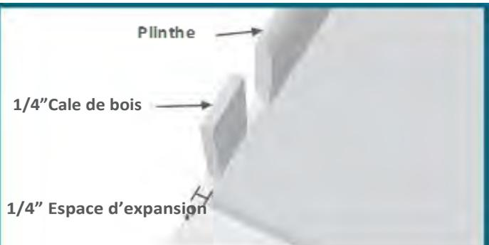
Laissez au moins 1/4" de joints d'expansion entre le plancher et TOUT objet vertical (murs, cabinets, etc.). De longues installations de plancher nécessiteront un joint d'expansion additionnel. Coupez le bas des châssis de porte pour allouer un espace adéquat d'expansion.
